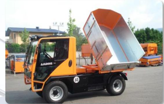
T-1250 benne basculante et pivotante
