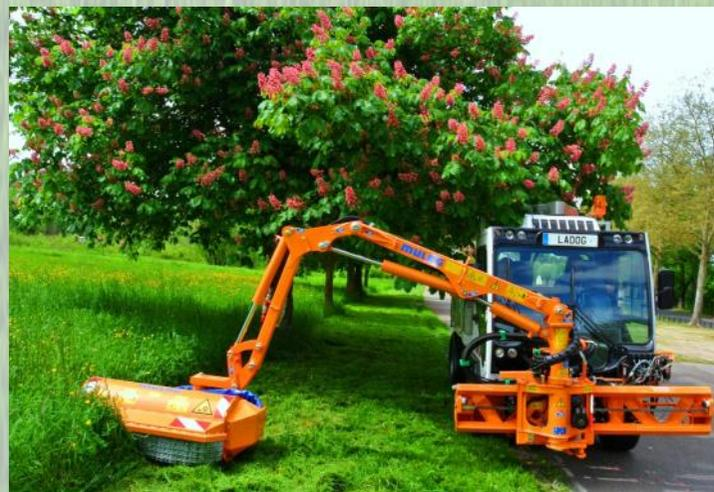
LADOG T-1550 avec débroussailleuse frontale. Le blocage de suspension hydraulique sur le pont avant, confère une énorme stabilité latérale et garantit des résultats de travail précis
