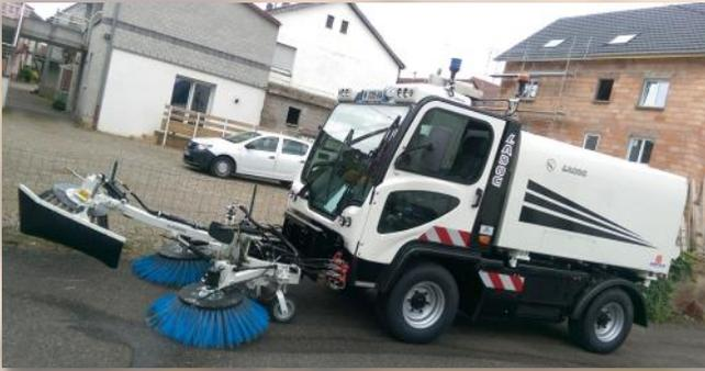
T-1700 Balayeuse 3 m<sup>3</sup> avec 2 brosses balayage jusqu' à 2,1m avec 3ième brosse métallique de desherbage
