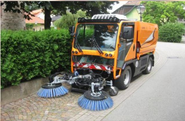
La « balayeuse classique » LADOG T-1250 avec 2 brosses, 2 m<sup>3</sup>, balayage jusqu' à 2,1m
