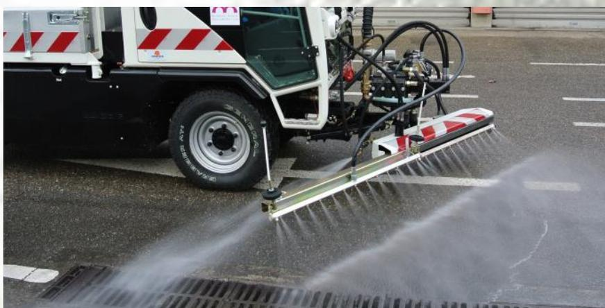
LADOG T-1250 avec rampe de lavage, télescopique haute-pression et jet latéral
