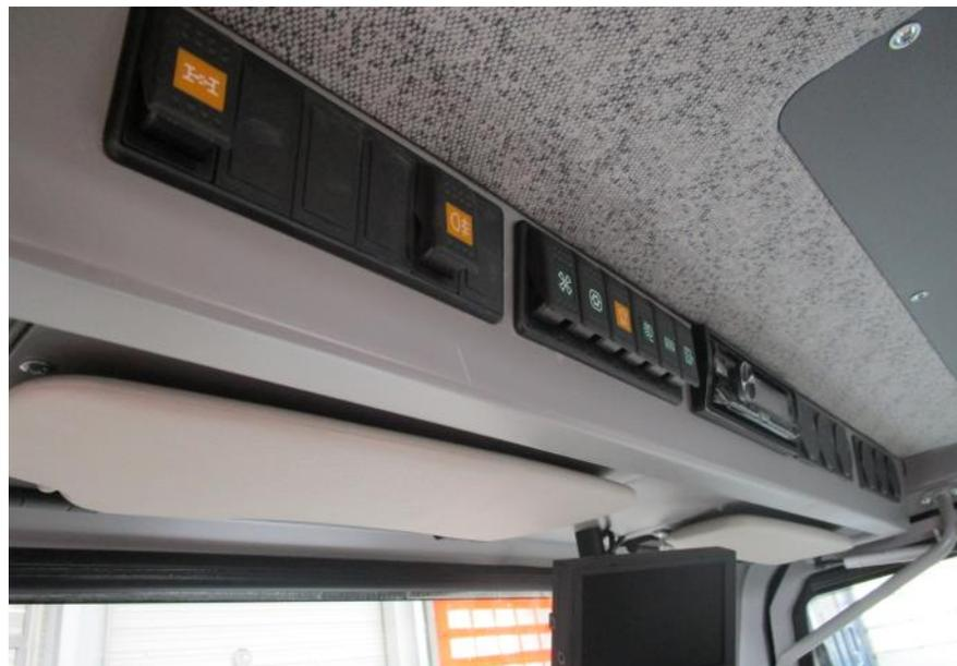
Divers boutons fonctionnels, radio, chauffage, climatisation, blocages, gyrophares, logés de manière bien ordonnée, sont facilement accessibles dans la console du toit.
