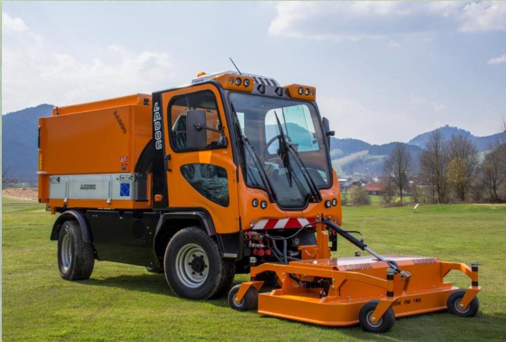
Une application à la fois classique et maintes fois éprouvée. LADOG T-1400 avec faucheuse frontale et conteneur d'aspiration monté dans la benne. L'herbe tondu est aspirée par le canal central LADOG
