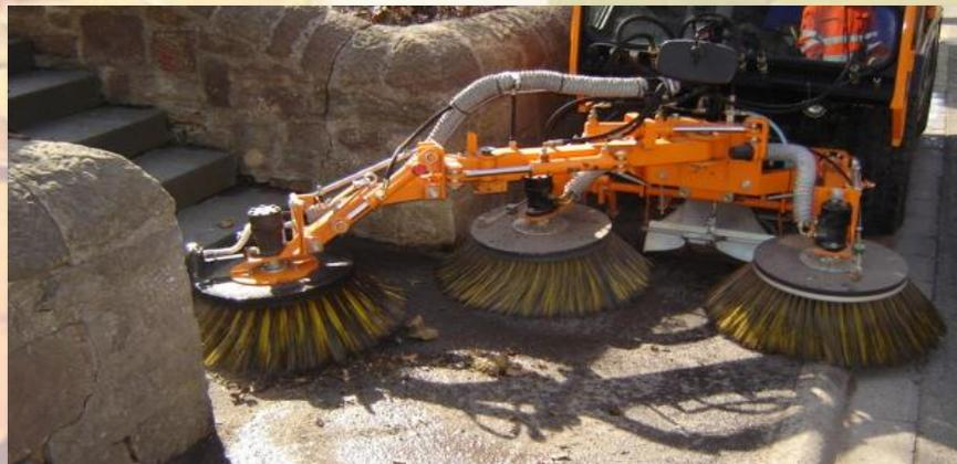
LADOG T-1150 avec troisième balai de recherche pour le nettoyage de trottoirs étroits et d'espaces particulièrement restreints (jusqu'à 2,5 m de balayage)
