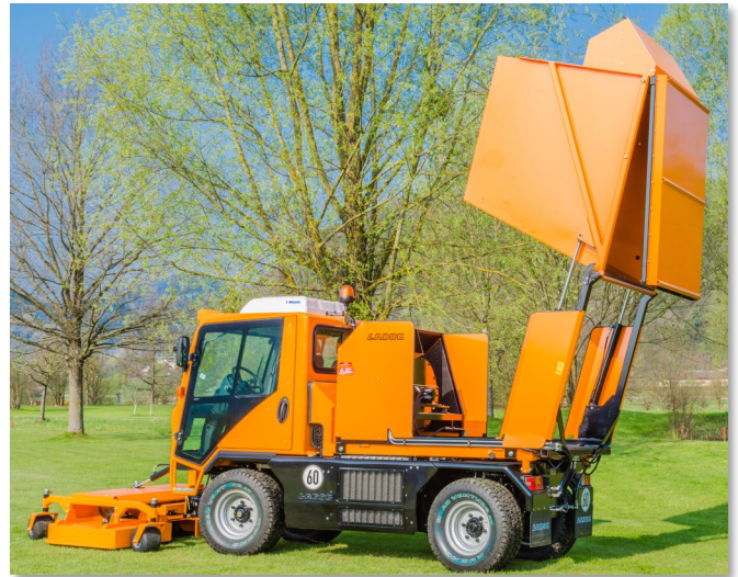
Hochkipptleerung des Containers erfolgt mit zwei leistungsstarken Hydraulikzylindern. Ideal für die Entleerung in Sammelcontainer
