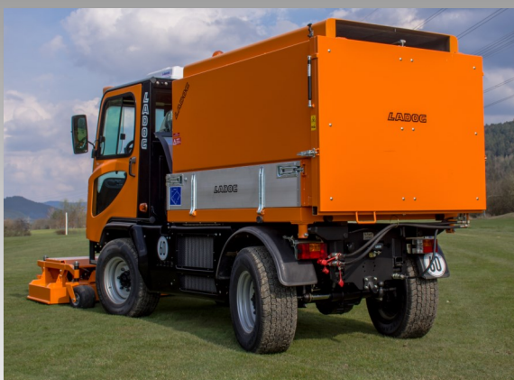
Der Mähcontainer LGSC-MA hat ein Fassungsvermögen von ca. 2 m 3 und lässt sich bequem auf der Pritsche befestigen
