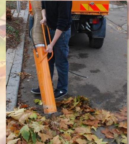
Flexible Absaugung mit optionalem Handsaugrohr
