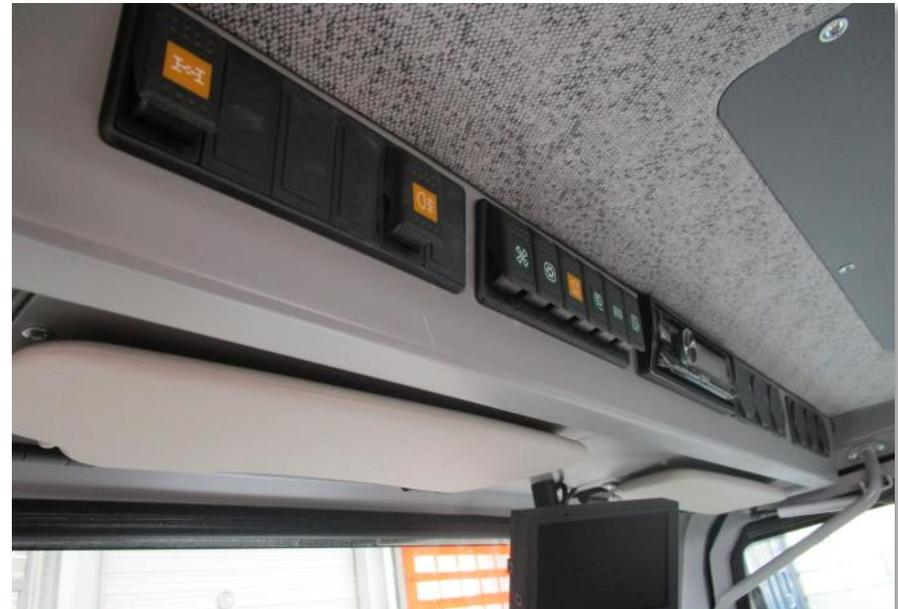
Diverse Funktionsschalter, Radio und Fahrtenschreiber etc. sind übersichtlich und bequem erreichbar in der Dachkonsole untergebracht
