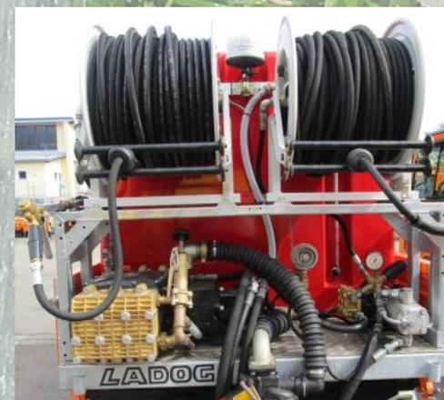
LADOG T-1250 Wasserpumpenaufbau
