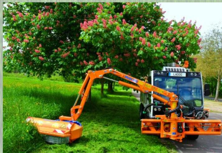
LADOG T-1550 mit Auslegemähkopf. Die zuschaltbare Pendelsperre der Vorderachse ermöglicht eine enorme Seitenstabilität und garantiert professionelle Arbeitsergebnisse
