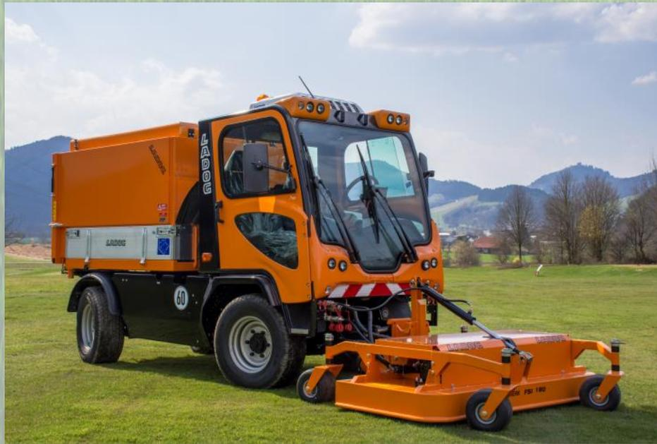
Eine klassische und vielfach bewährte Anwendung. LADOG T-1400 mit Frontsichelmäher und Saugcontainer auf der Ladefläche. Die Absaugung des Mähguts erfolgt durch die LADOG-Mittelkanaltechnik
