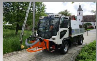
T1700 mit Gießanlage
