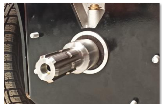
Der Antrieb von diversen Anbaugeräten erfolgt über eine Zapfwelle
