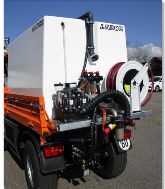
LADOG T1250 mit 2000L Wasserfass und Pumpenaufbau
