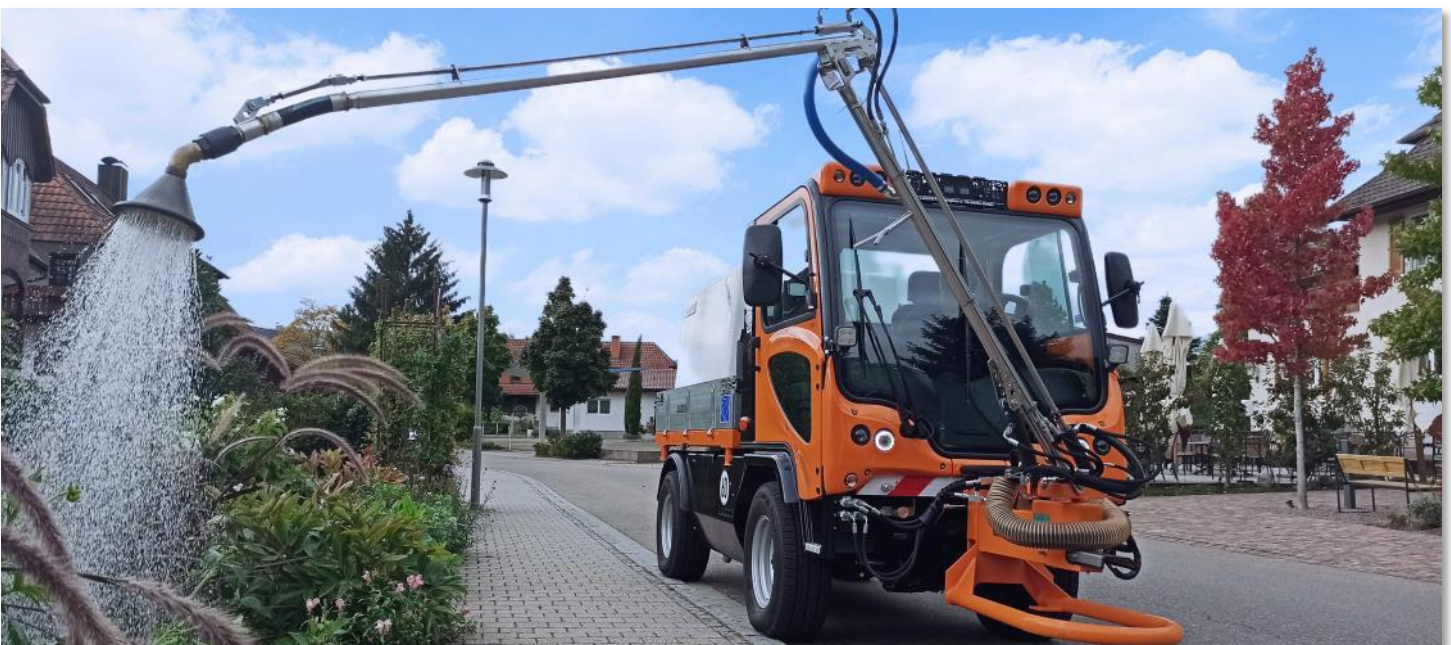
LADOG T1400 mit Gießanlage und 2000L Wasserfass
