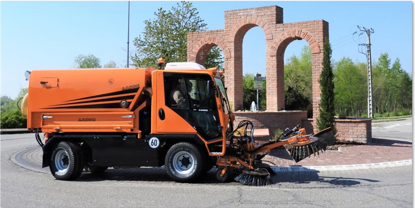
Die „klassische Kehrmaschine“ LADOG T1250 mit 2-Besen-Kehraggregat, Wildkrautbürste und Kehrmaschinenaufbau K2
