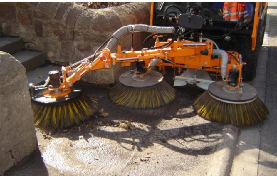
LADOG T1150 mit Kehraggregat und drittem Besen für den Einsatz auf schmalen Gehwegen und in besonders beengten Verhältnissen
