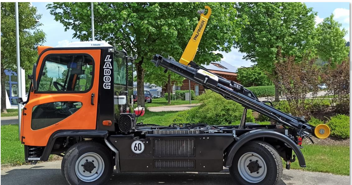
LADOG „Spezialität“: kippbarer Hakenliftaufbau (für Wartungsarbeiten am Motor und Getriebe )
