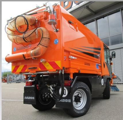
Rückansicht Kehrmaschinenaufbau mit Handsaugschlauch und Ausleger für schwer erreichbare Stellen (z.B. unter Parkbänken)
