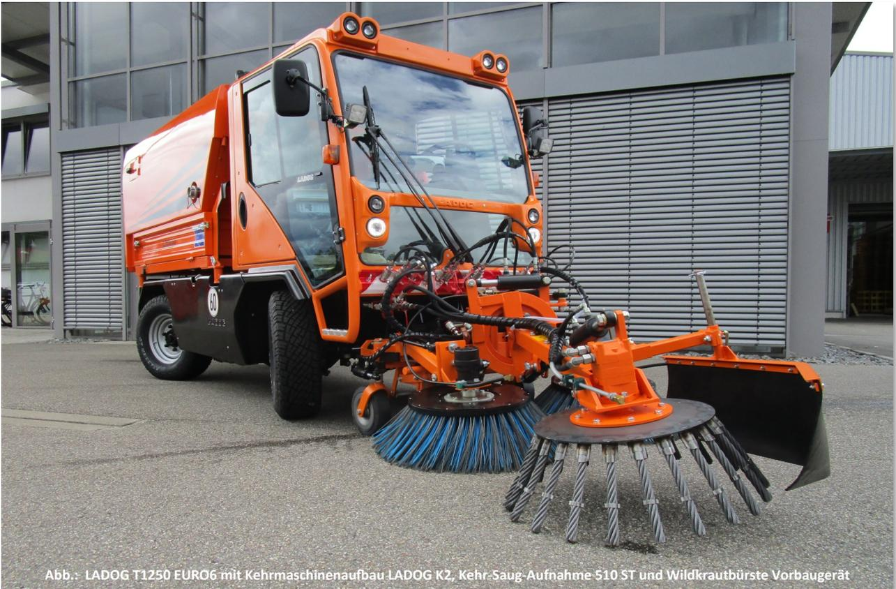
Abb.: LADOG T1250 EURO6 mit Kehrmaschinenaufbau LADOG K2, Kehr-Saug-Aufnahme 510 ST und Wildkrautbürste Vorbaugerät
