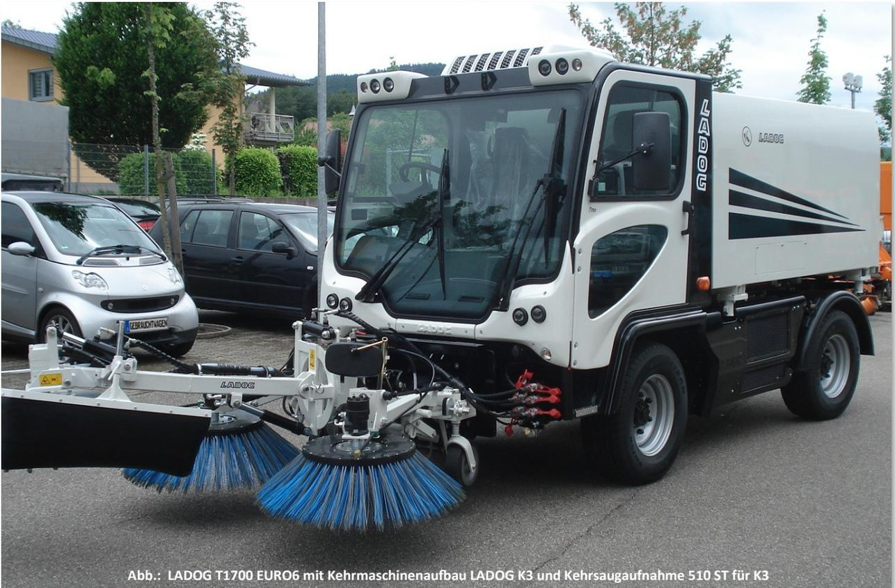
Abb.: LADOG T1700 EURO6 mit Kehrmaschinenaufbau LADOG K3 und Kehrsaugaufnahme 510 ST für K3
