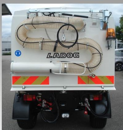
Rückansicht Kehrschinenaufbau mit Handsaugschlauch und Ausleger für schwer erreichbare Stellen (z.B. unter Parkbänken)
