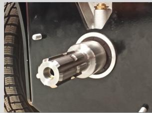
Der Antrieb von diversen Anbaugeräten erfolgt über eine Zapfwelle
