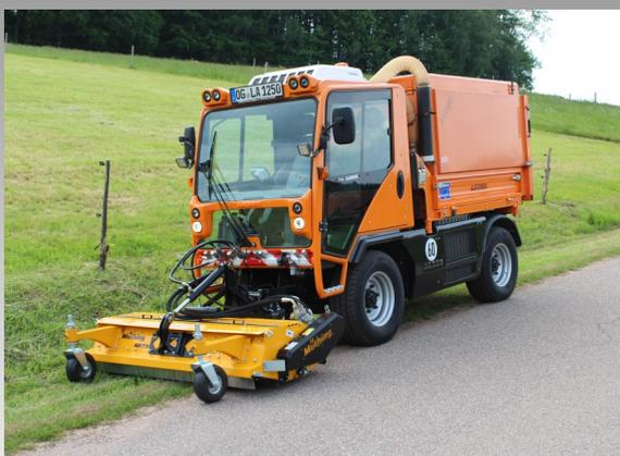
LADOG T1250 mit Mittelkanalabsaugung, Schlegelmulcher und Mähcontainer LGSC-MA
