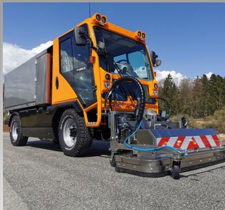
T1250 mit NOTHHELFER-Aufbau für die Intensivreinigung diverse Beläge
