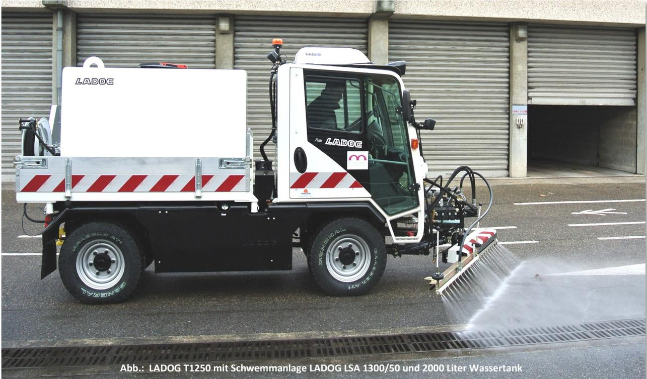
Abb.: LADOG T1250 mit Schwemmanlage LADOG LSA 1300/50 und 2000 Liter Wassertank
