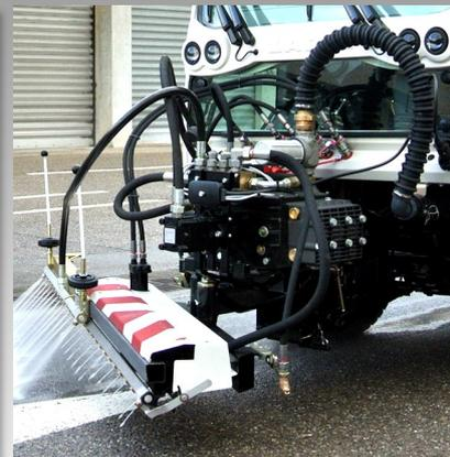
Integrierte hydraulisch angetriebene Wasserpumpe mit 161 Liter / 60bar
