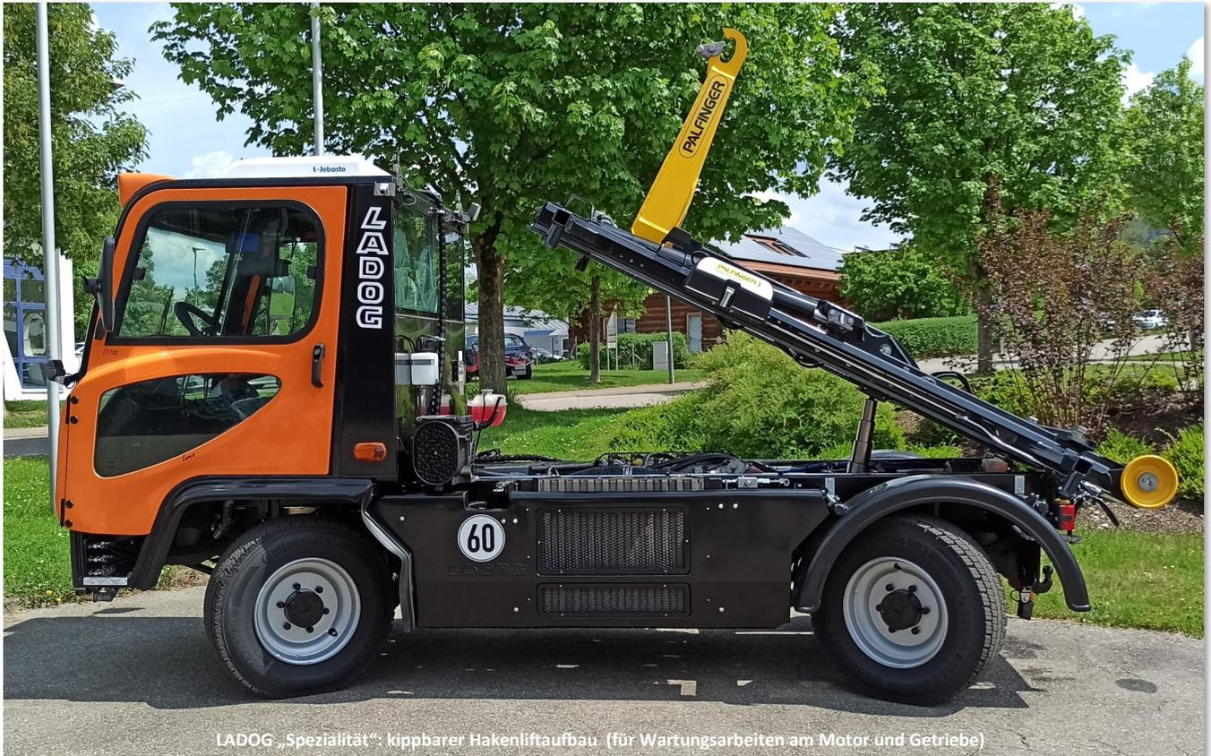
LADOG „Spezialität“: kippbarer Hakenliftaufbau (für Wartungsarbeiten am Motor und Getriebe)
