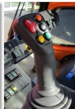
Für die Bedienung der Hydraulikfunktionen stehen verschiedene Steuerungsmöglichkeiten zur Verfügung
