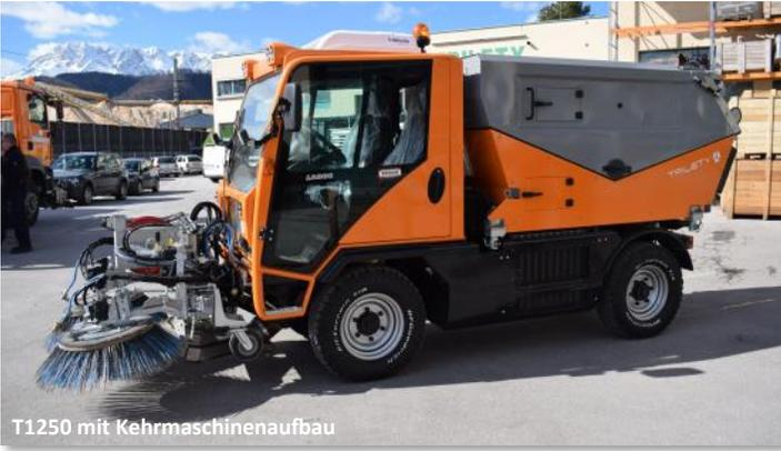
T1250 mit Kehrmaschinenaufbau
