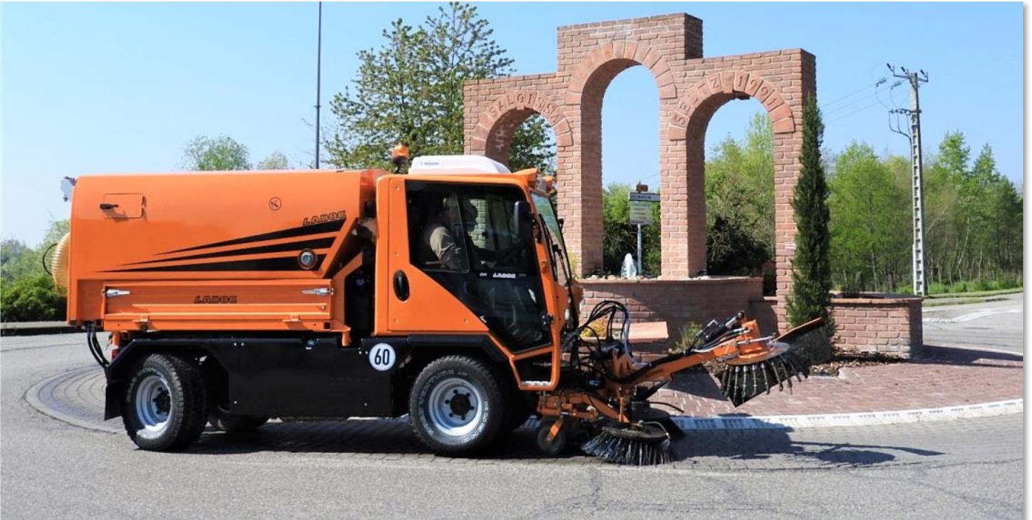
Die „klassische Kehrmachine“ LADOG T1250 mit 2-Besen-Kehraggregat, Wildkrautbürste und Kehrmaschinenaufbau K2
