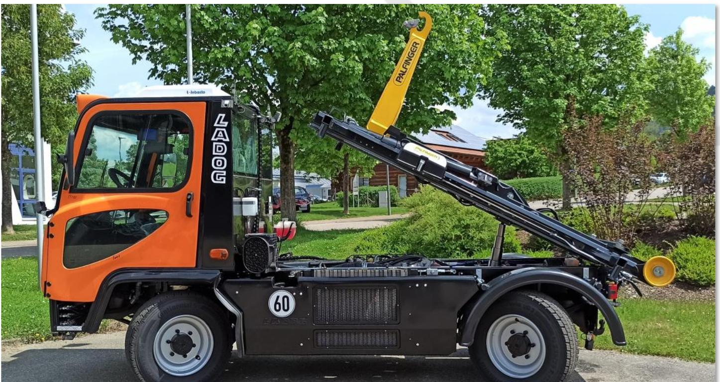
LADOG „Spezialität“: kipparer Hakenliftaufbau (für Wartungsarbeiten am Motor und Getriebe )
