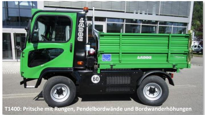
T1400: Pritsche mit Rungen, Pendelbordwände und Bordwänderhöhungen
