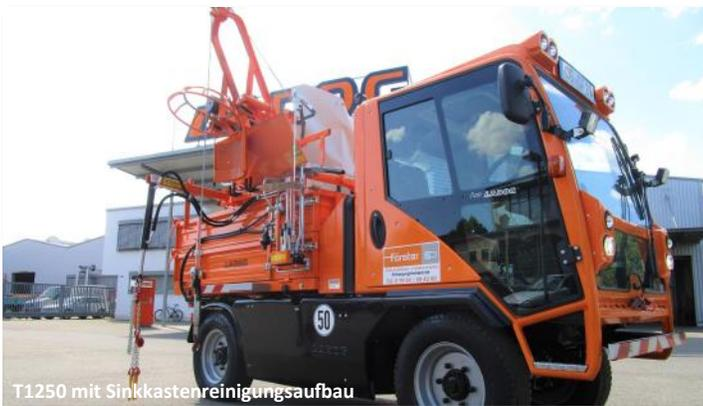
T1250 mit Sinkkastenreinigungsaufbau
